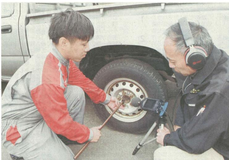
打音検査でナットの緩みのデータを収集する浅川拓克准教授(右)と柴田翔さん(15日、八戸工業大)
