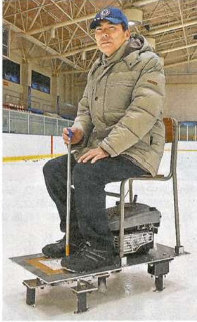
スケートリンクでトロコイド推進ロボットの氷上操縦性などを確認する武藤准教授
