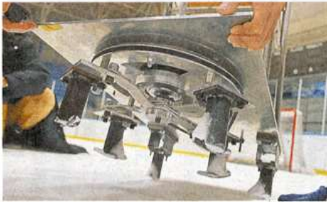
トロコイド推進ロボットの駆動部。細い長方形の板についたブレードが円回転し推進力を生み出す
